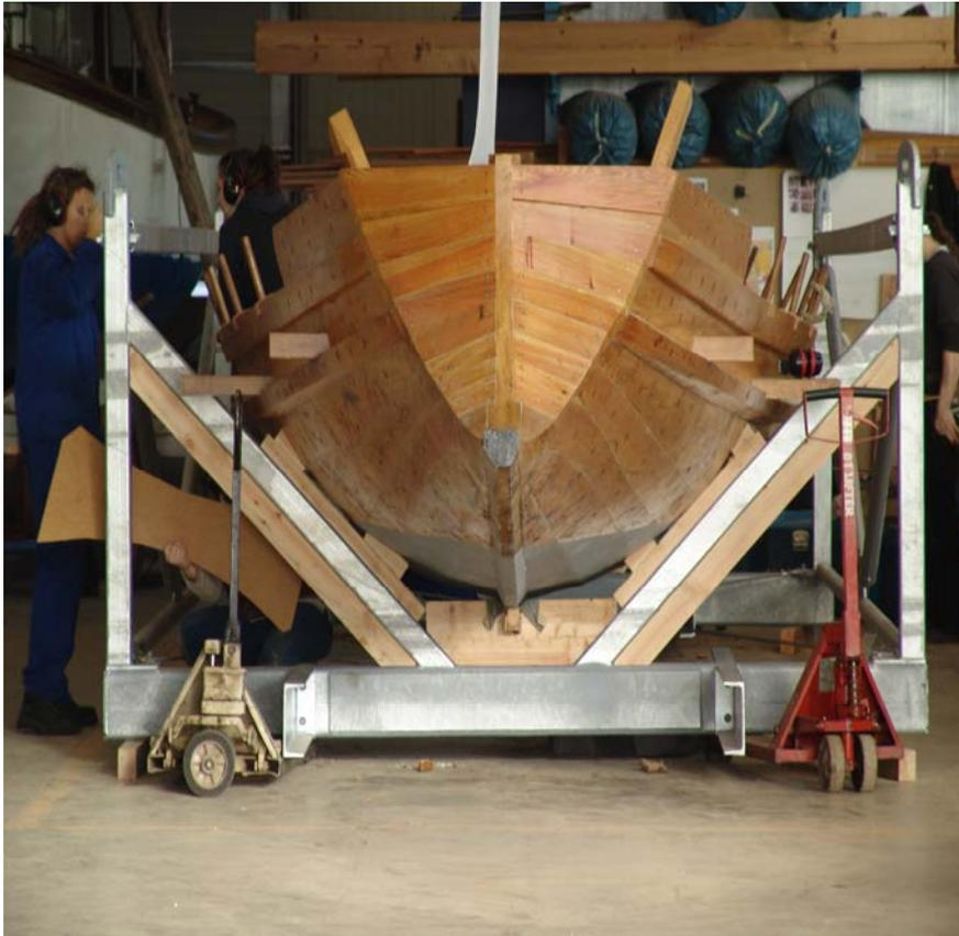
Schon die Rekonstruktion an sich brachte eine Fülle neuer Erkenntnisse im Hinblick auf die antike Schiffsbautechnik. Da galt es zum einen, die optimale Form der Holznägel zu finden, mit denen die Planken am Spantgerüst befestigt werden sollten. Die Legierung der Eisennägel wurde analysiert.<sup>8</sup>
