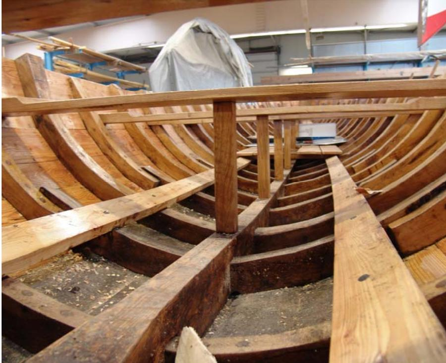
Schon die ersten Minuten an den Riemen machten dagegen deutlich, dass hier keinerlei überflüssiger Platz zwischen den Ruderern zur Verfügung stand. Ein dritter Mann auf der Bank hätte den Ruderantrieb nahezu lahm gelegt. Untersuchungen hinsichtlich der Stabilität des Rumpfs belegen, dass die Stützen vielmehr zur Versteifung des Schiffskörpers dienten und ein Verwinden des Rumpfes verhinderten, das einen erhöhten Wasserwiderstand und einen stärkeren Verschleiß zur Folge hätte.<sup>13</sup>
