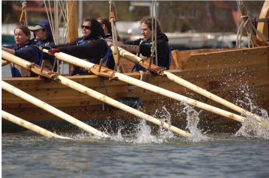
Das Gesamtgewicht des Oberstimmsschiffes vom Typ 1 ohne Rigg, Riemen, Ruder und Besatzung liegt bei 2,3t. Insgesamt kommt man mit Besatzung, Rigg, Riemen, Ankern und Steueranlage auf ein Gewicht von 4,1 – 4,2t.<sup>14</sup>
