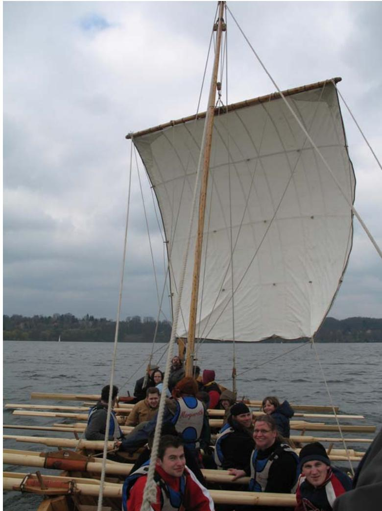
**Abb. 19: Segelstellung bei Halbwindkurs**
